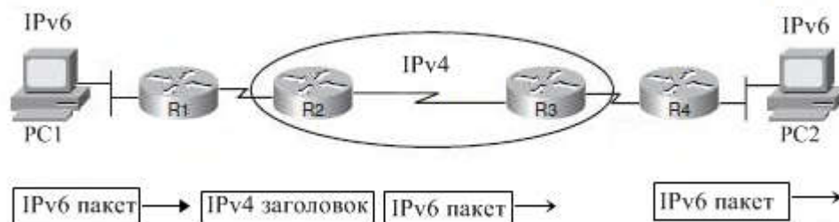
Рисунок 3.1 – Приклад IPv6 to IPv4 тунеля
