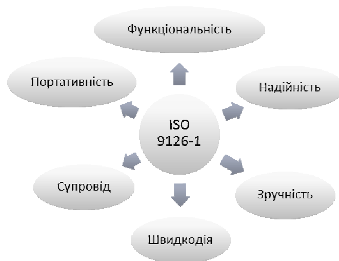
Рисунок 2 – Модель якості програмного забезпечення ISO 9126-1
