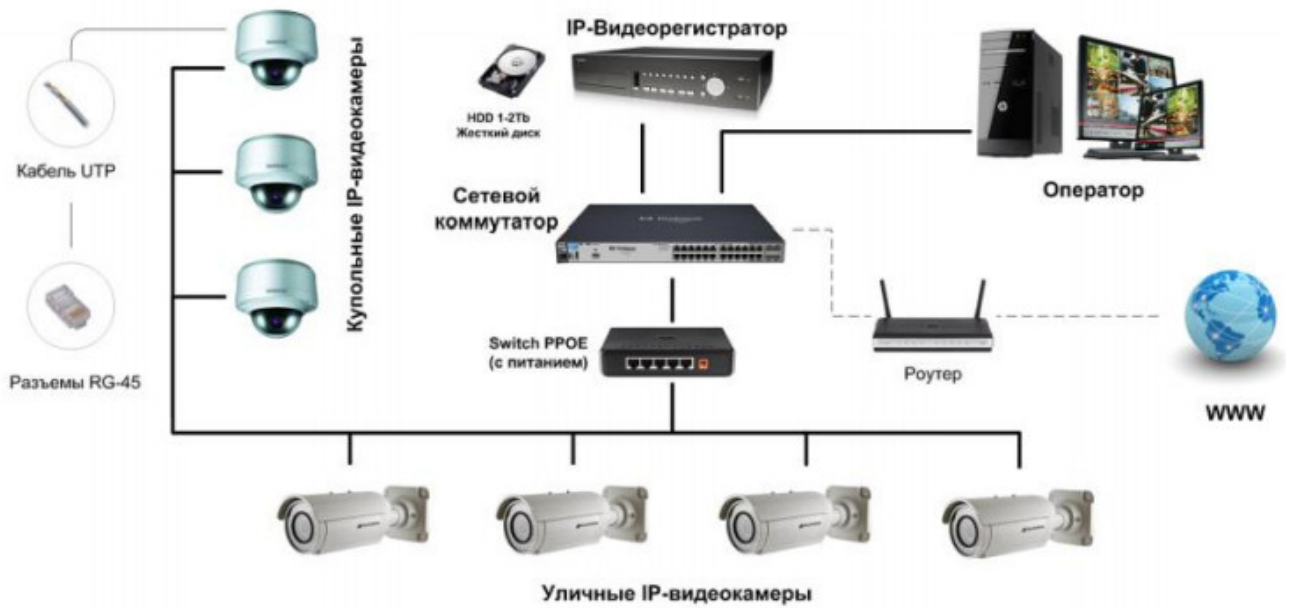
Рисунок 1.7 Схема будови системи IP відеоспостереження
