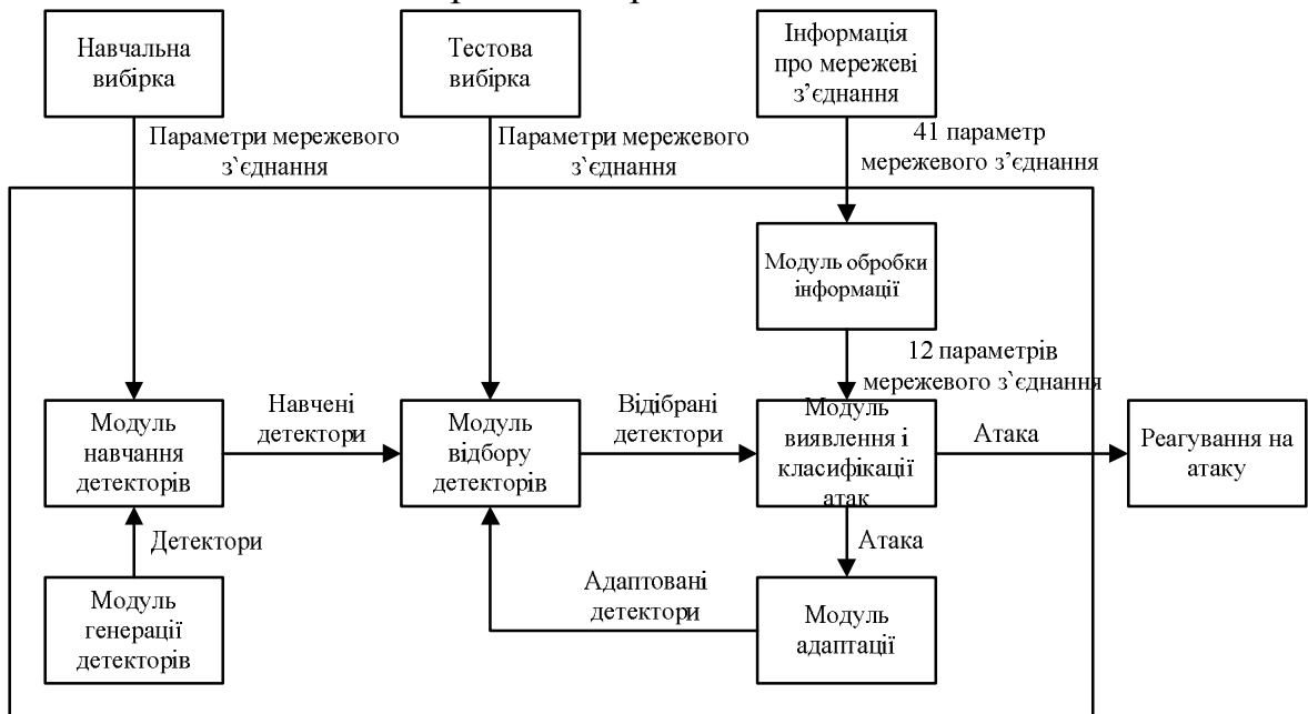
Рисунок 4 – Структура нейромережевої імунної системи виявлення і класифікації атак на ІТМ
