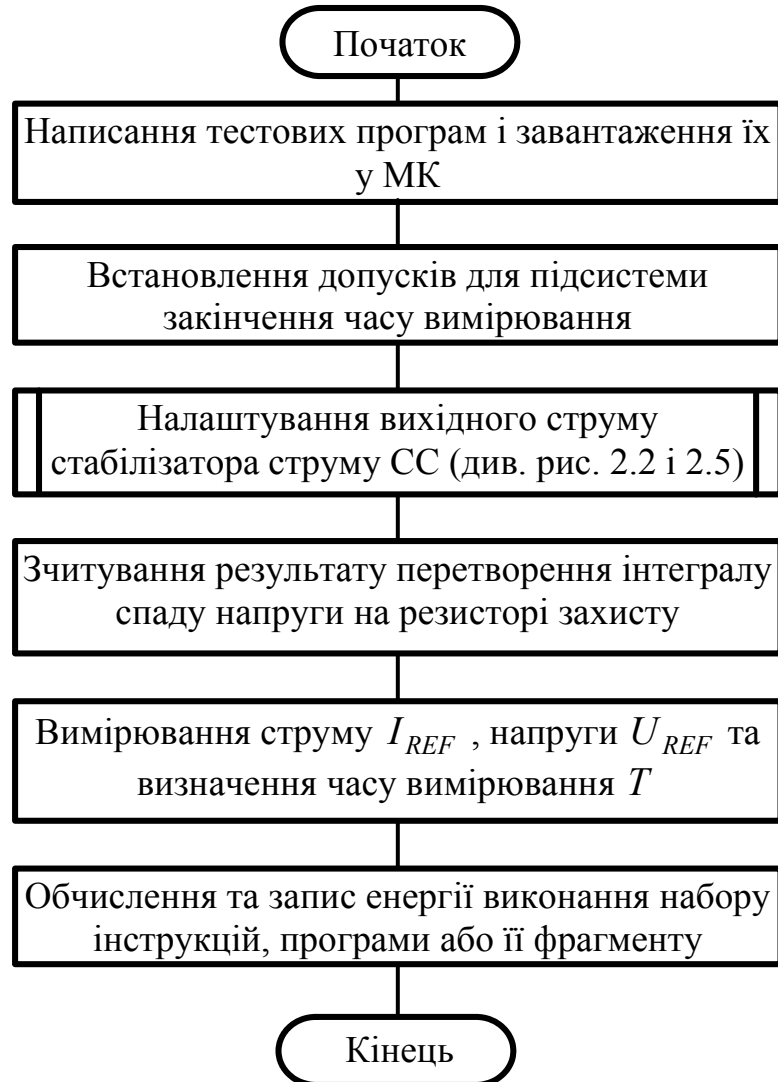
Рисунок 4.7 – Узагальнений алгоритм роботи підсистем ІВС середнього енергоспоживання МК
