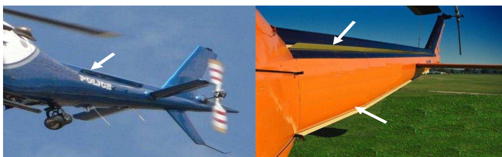
Рисунок 1 – Одиночний і подвійні гребені хвостової балки вертольотів
