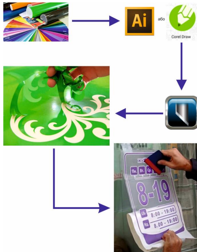
Рисунок 1 – Стадії виготовлення продукції за допомогою плоттера
