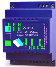
Рисунок 2.8 – Зовнішній вигляд джерела живлення
