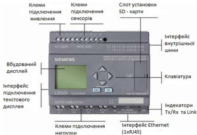
Рисунок 3.1 – Будова контролера Siemens Logo 0BA7
