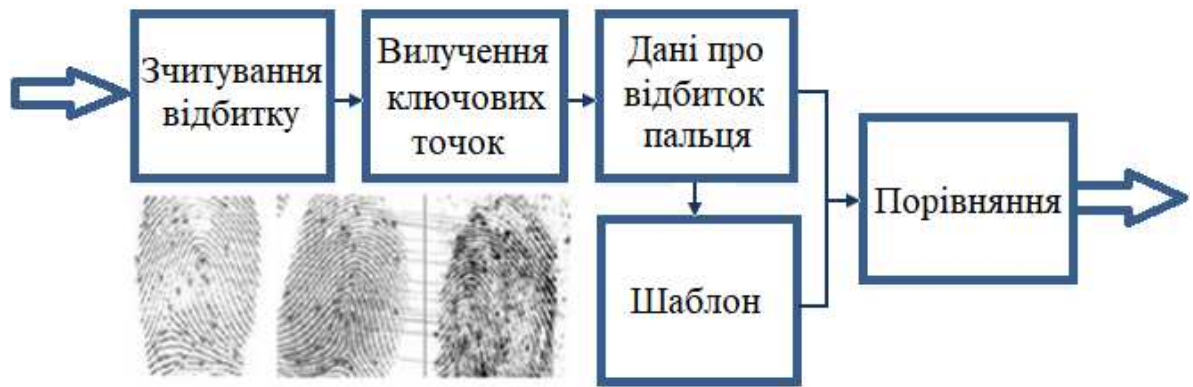
Рисунок 2.2 – Процес розпізнавання відбитків
