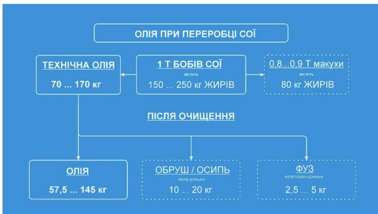
Рис. 1. Технологія переробки сої на олію і вихід олії [43]
