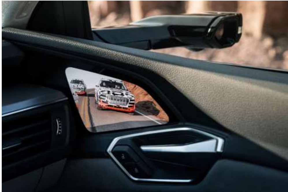
Рис.2.9. Віртуальні бокові дзеркала Audi E-tron [38]
