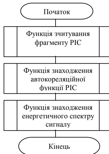
Рисунок 2 - Алгоритм функціонування програмного модуля опрацювання РІС
