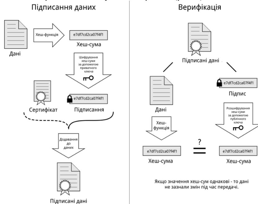
Рисунок 1 – Структурна схема процесу передавання повідомлення з електронним цифровим підписом та перевірка достовірності повідомлення
