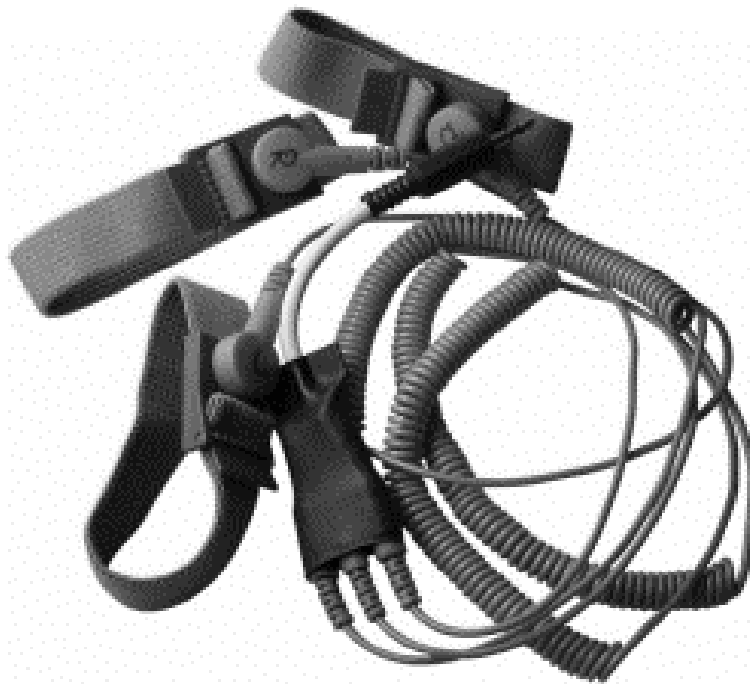
Рис. 4.5. Пасивні електроди для електрокардіографії та електроміографії
