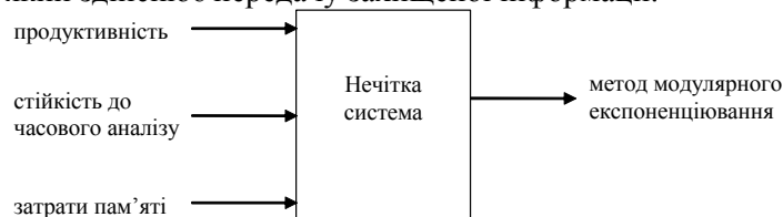
Рисунок 1 – Нечітка система вибору методу модулярного експоненціювання
