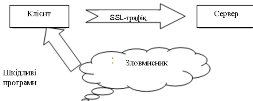
Рисунок 1 – Схема атаки посередника на протокол SSL/TLS
