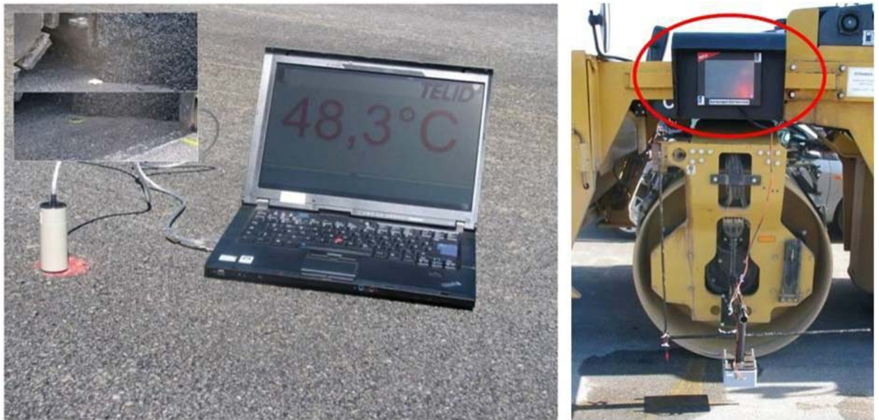
Рисунок 2.15- Встановлення пасивних датчиків температури та зчитування поточної температури асфальту в укладеному шарі (ліворуч) і блок індикації температури на котку (праворуч)
