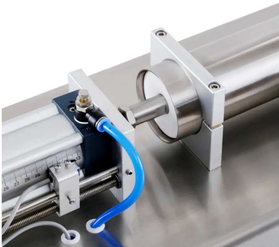
Рисунок 1.8 – Кріплення сенсора біля циліндра актуатора.
