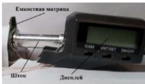
Рисунок 1.5 – Складові елементи вимірювального вузла
