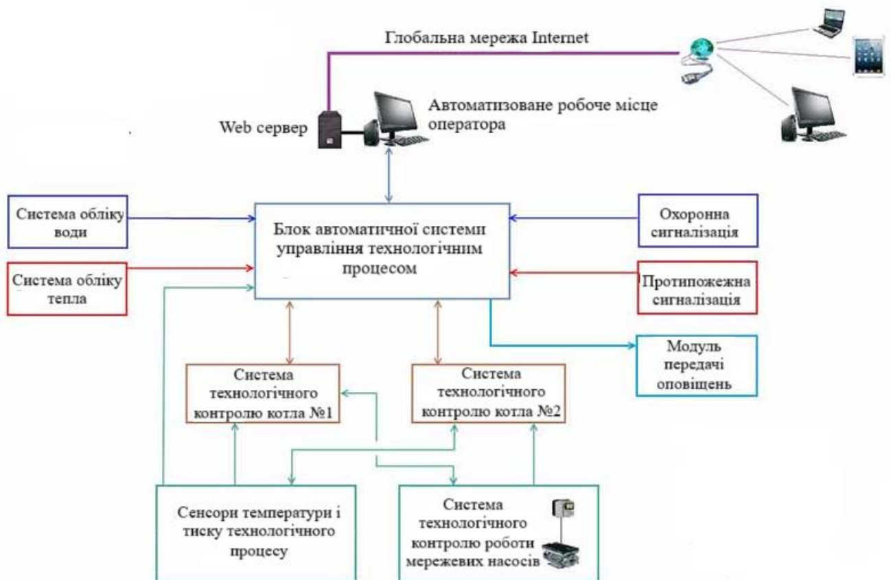
Рисунок 2.5 – Функціональна схема автоматизованої системи керування КУ
