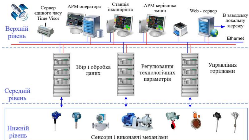
Рисунок 2.3 – Архітектура ієрархічних рівнів АСУ ТП котельної установки
