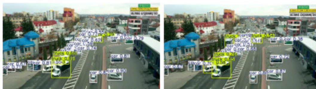
Рисунок 2 – Виявлення і класифікація об'єктів за допомогою за допомогою алгоритму YOLO8 (зліва) та YOLO11 (справа)
