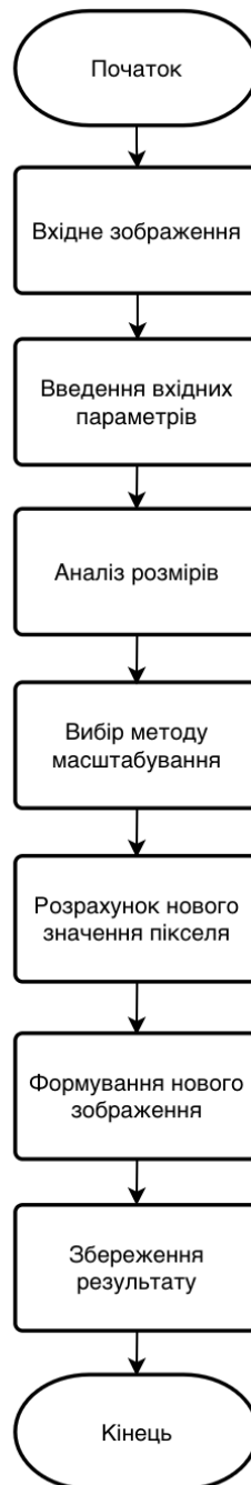
Рисунок 2.3 – Схема алгоритму масштабування зображень
