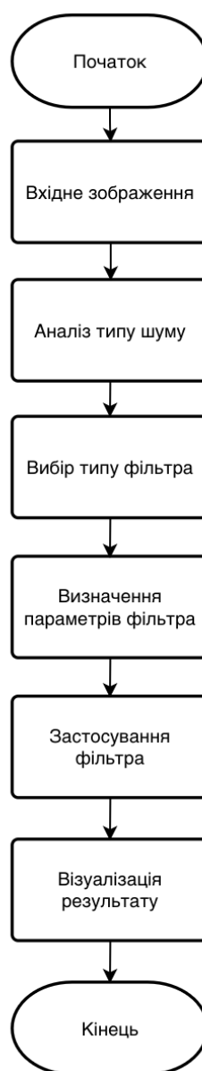
Рисунок 2.2 – Схема алгоритму фільтрації шумів
