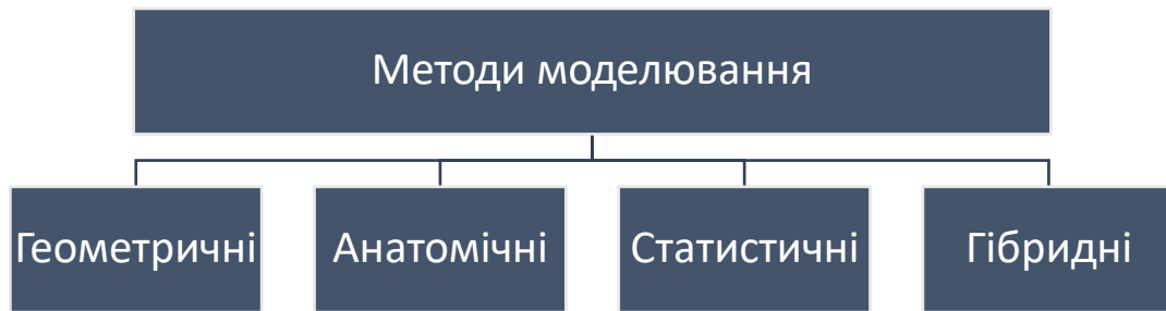
Рисунок 1.1 – Класифікація існуючих методів моделювання обличчя людини в біометричних системах
