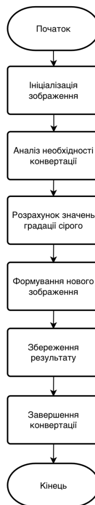
Рисунок 2.5 – Схема алгоритму обробки кольорів
