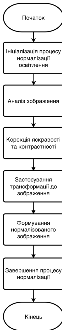
Рисунок 2.7 – Схема алгоритму нормалізації освітлення
