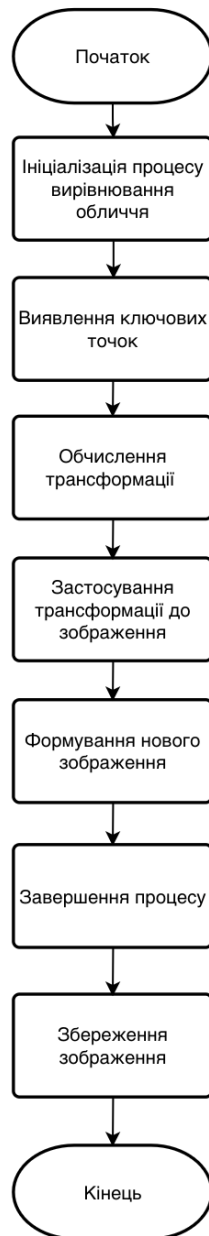
Рисунок 2.6 – Схема алгоритму вирівнювання обличчя людини
