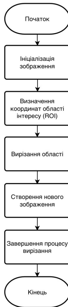
Рисунок 2.4 – Схема алгоритму вирізання
