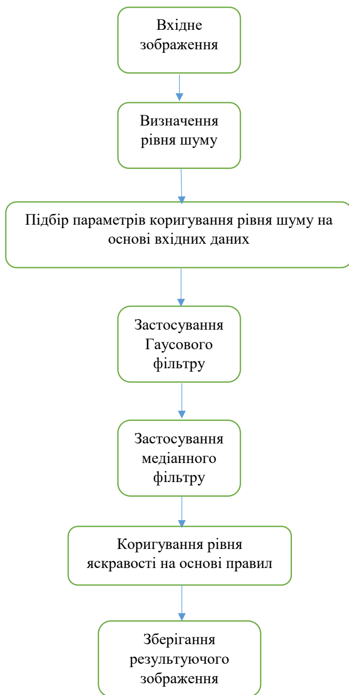
Рисунок 2.1 - Алгоритм адаптивного покращення якості зображень
