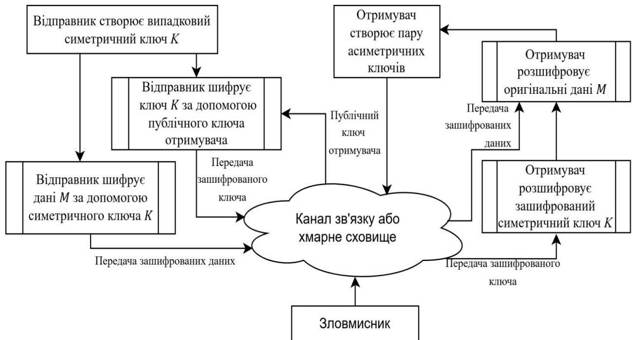
Рисунок 2.3 - Загальна схема гібридного шифрування
