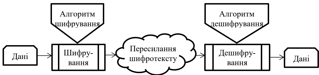
Рисунок 1.1 - Принцип шифрування та дешифрування
