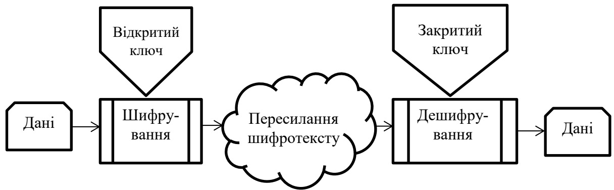
Рисунок 1.3 - Процес асиметричного шифрування
