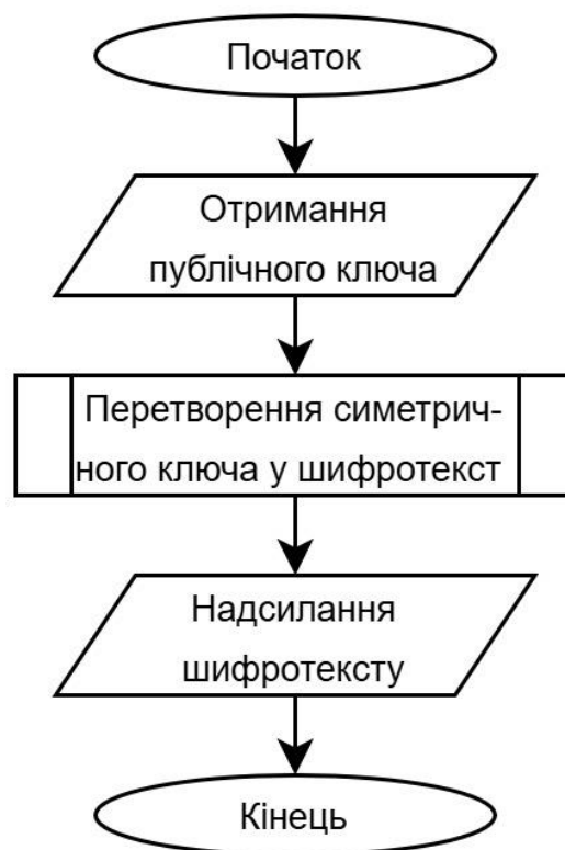
Рисунок 3.2 – Алгоритм шифрування симетричного ключа
