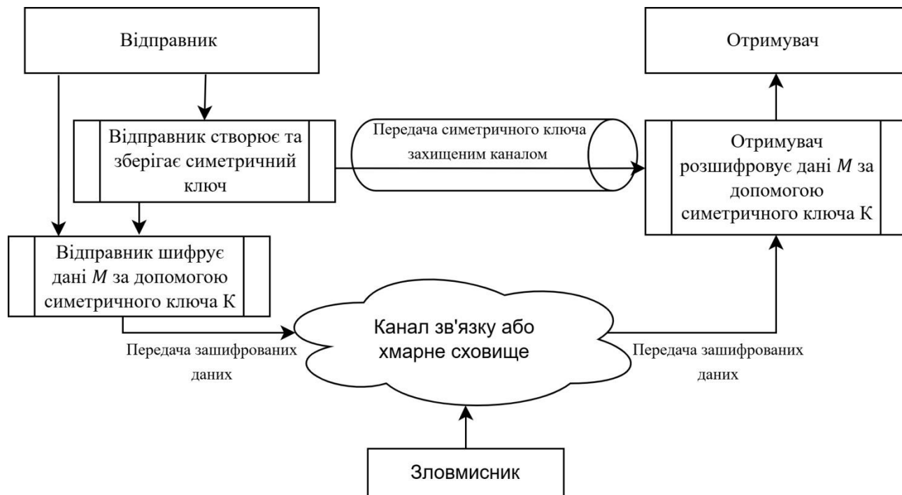
Рисунок 2.2 - Схема симетричного шифрування
