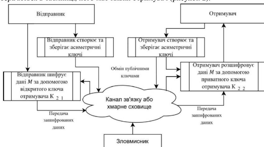
Рисунок 2 - Схема асиметричного шифрування
