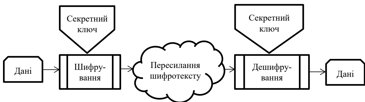
Рисунок 1.4 - Процес симетричного шифрування
