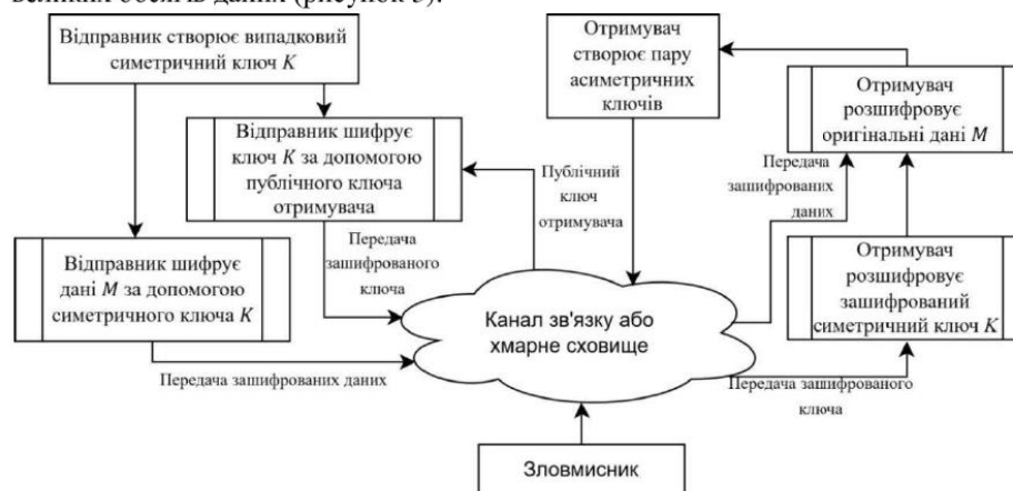
Рисунок 3 - Загальна схема гібридного шифрування
