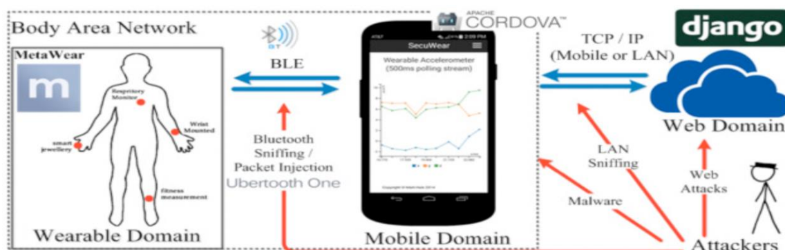
Рисунок 2.1 - Архітектура SecuWear та вектори атак на різні домени (носимі, мобільні та веб-сервіси) [34]
