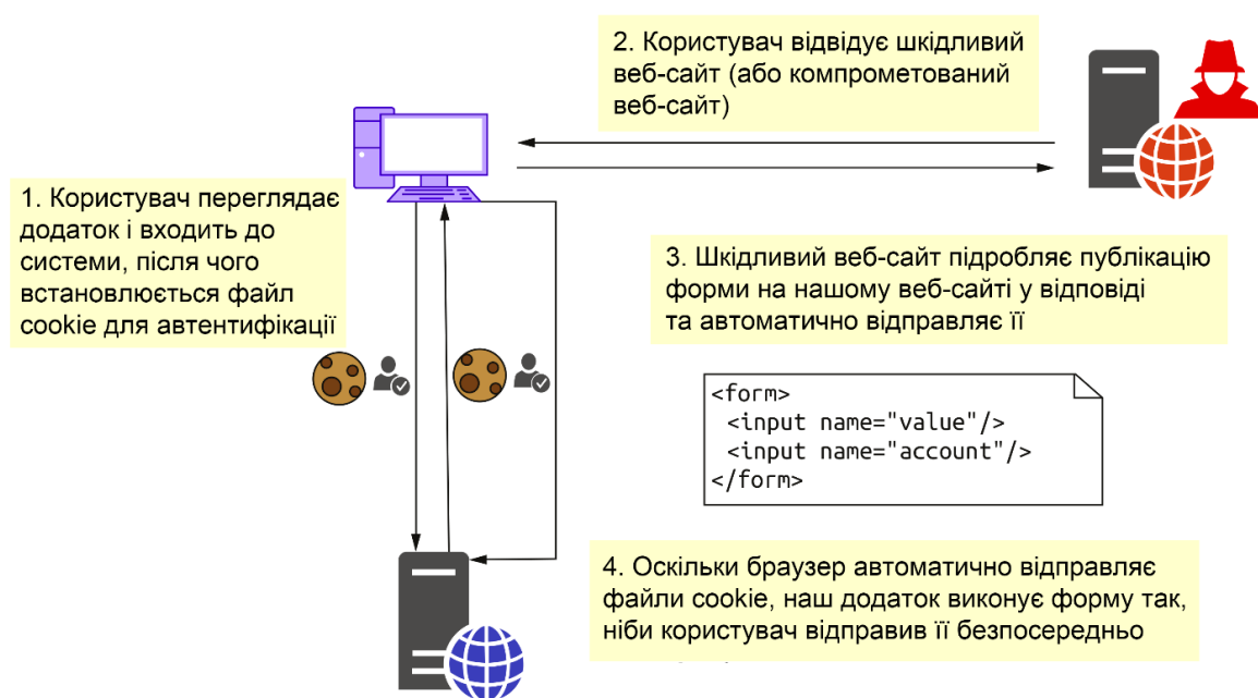
Рисунок 2.5 – Механізм експлуатації CSRF вразливості
