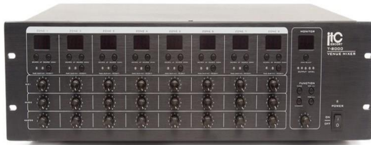
Рисунок 2.10 – Загальний вигляд матричний комутатор T-8000 ITC Escort
