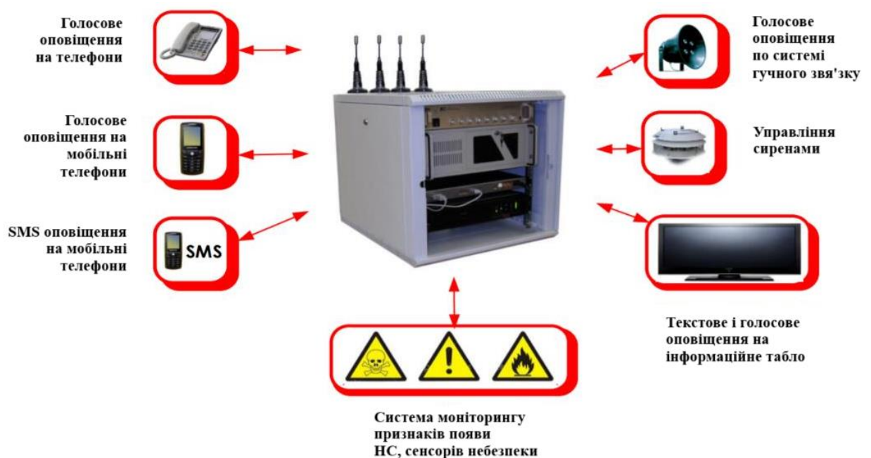
Рисунок 1.8 – Загальний вигляд системи оповіщення регіонального типу СІГМА П-161М РММ8
