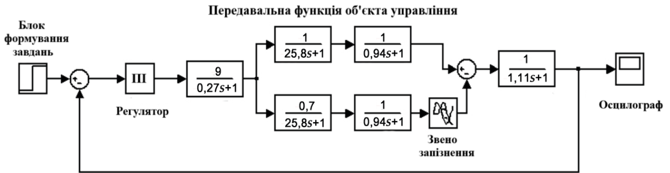
Рисунок 3.1 – Модель САР температури конденсату на виході з кожухотрубного теплообмінника
