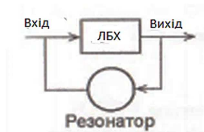
Рисунок 1.24 - Функціональна схема автогенератора на ЛБХ з резонатором в ланцюжку зворотного зв'язку
