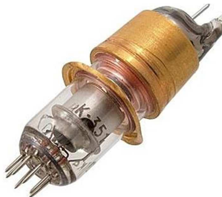
Рисунок 1.2 – Зовнішній вигляд клістону
