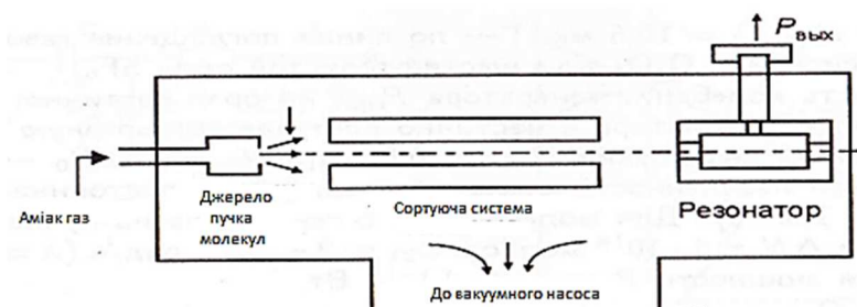
Рисунок 2.10 - Схема високо стабільного квантового генератора на пучку молекул аміака
