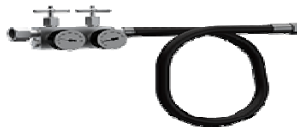
Рисунок 2.18- Пристрій для продувки й опресування систем автоматичного пожежогасіння
