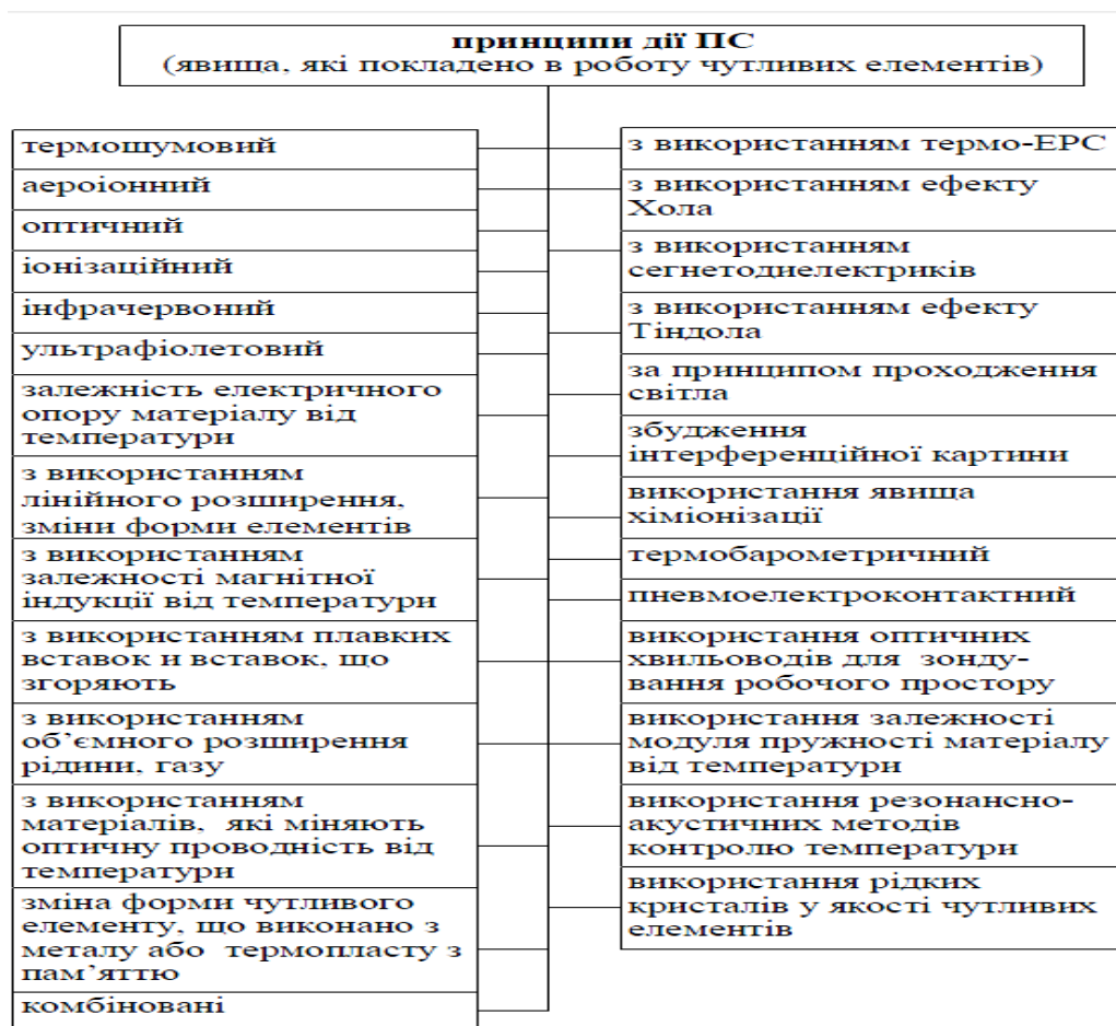
Рисунок 2.6- Демонструє класифікацію пожежних сповіщувачів відповідно до їх принципу дії
