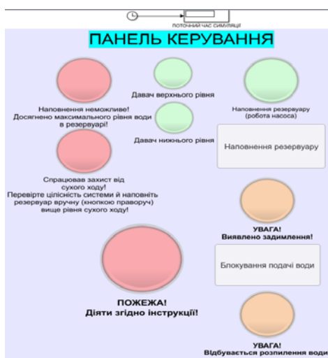
Рисунок 3.9 - Панель керування системою з індикаторами станів
