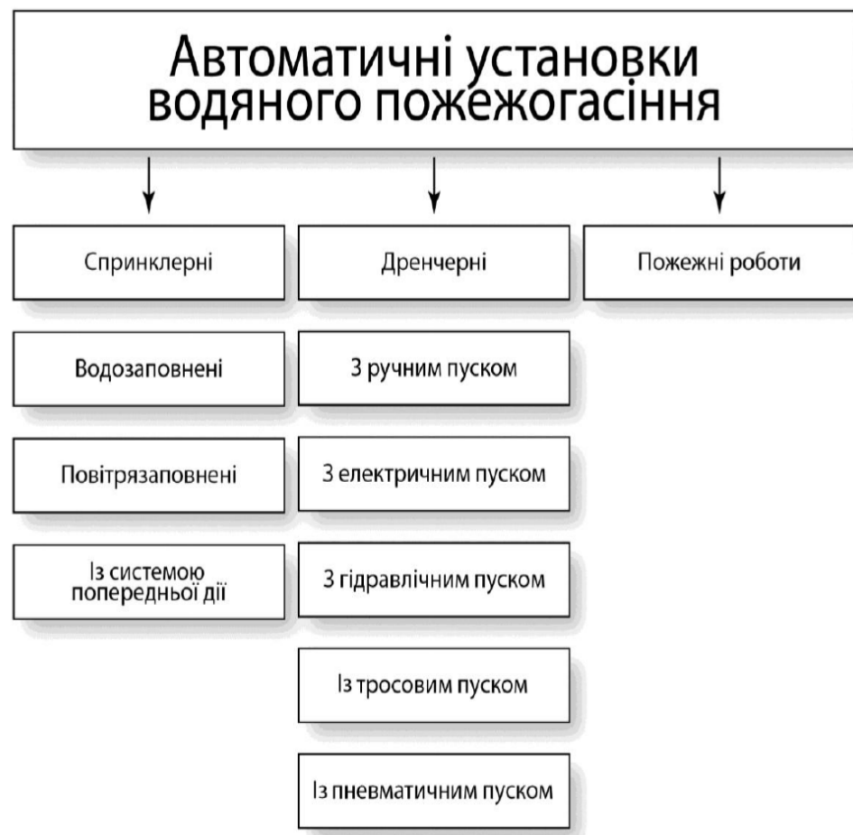
Рисунок 1.7 – Класифікація автоматизованих систем водяного пожежогасіння
