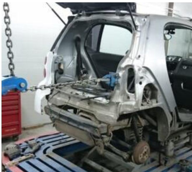
Рис. 1.4. Приклад процесу відновлення геометрії кузова
