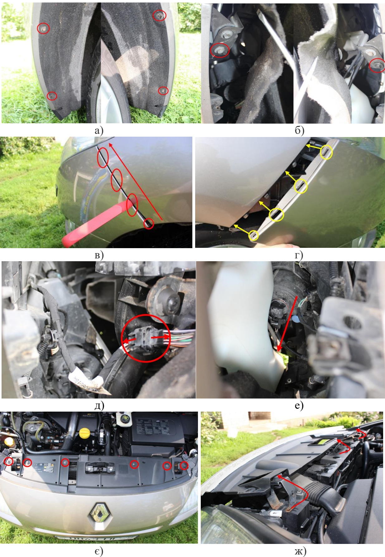
Рис. 1.3. Процесс демонтажу бампера Renault Scenic 3
