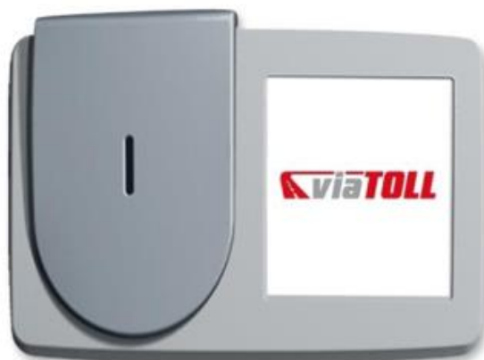
Рисунок 3.3 – Електронний прилад для оплати платних доріг Viatoll
