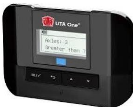
Рис. 3.4 – Електронний прилад для оплати платних доріг UTA
