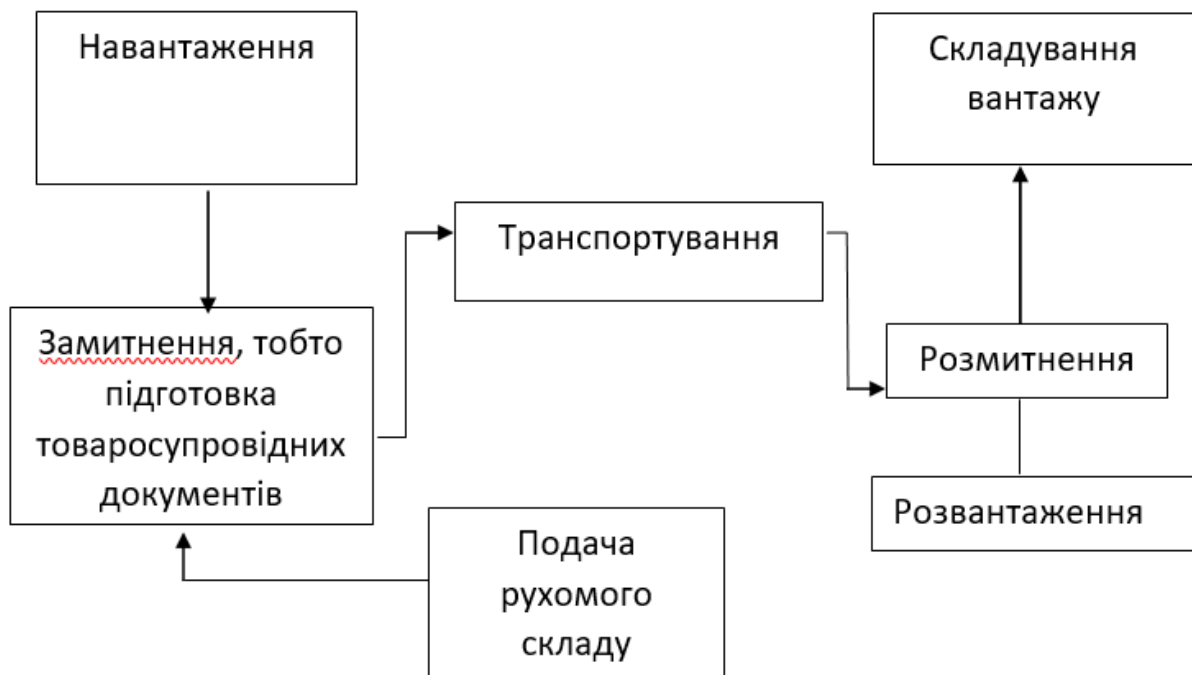
Рисунок 1.1 – Технологічна схема перевезення вантажів.
