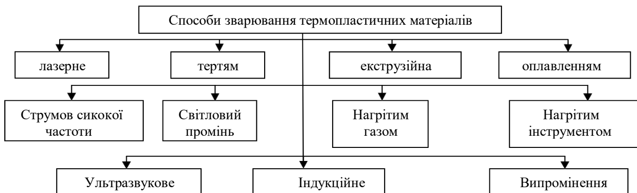
Рис. 1.3 Класифікація способів зварювання термопластичних матеріалів
