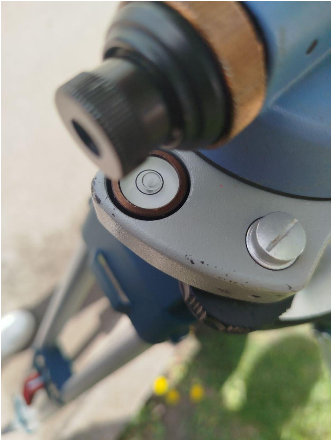
Рис. 4.3. Регулювання приладу і перевірка правильного вертикального встановлення антени
