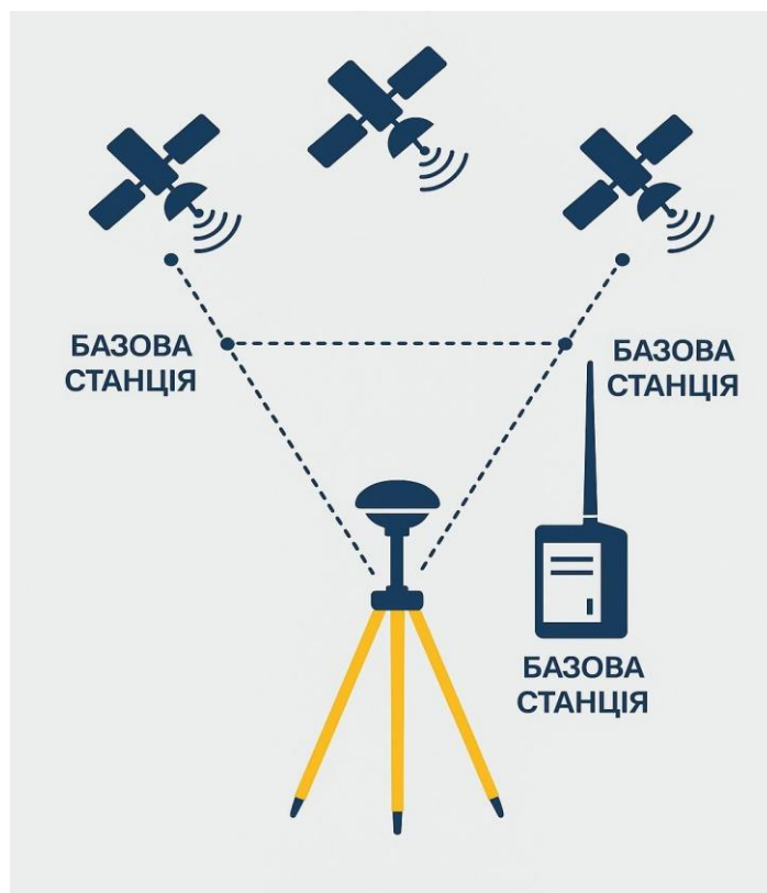
Рис. 2.2. Принцип роботи статичного методу
