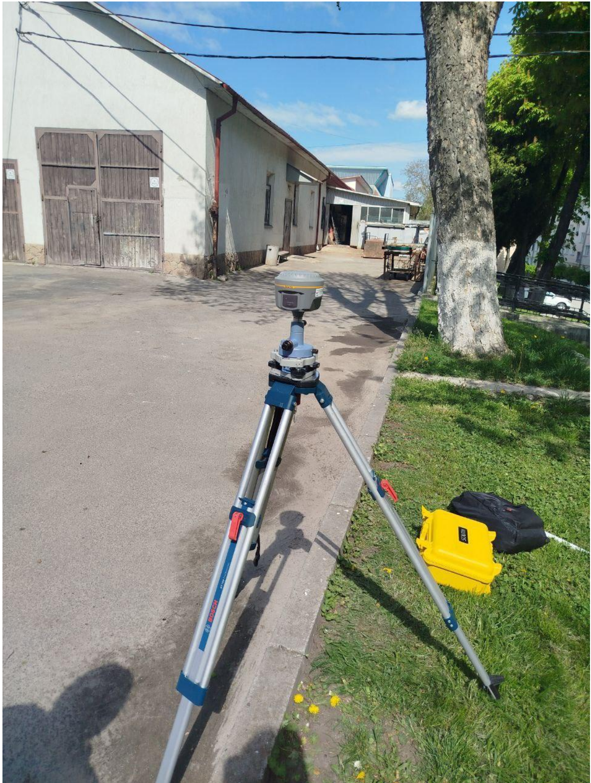
Рис. 4.2. Galaxy G1 встановлено з використанням триноги
