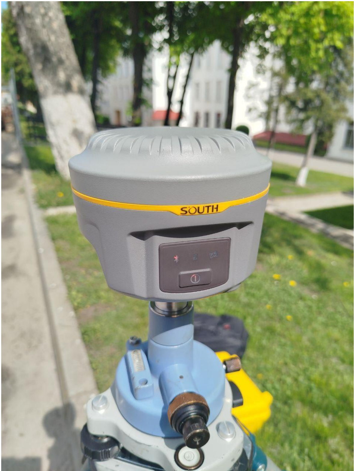
Рис. 4.1. GNSS-приймач Galaxy G1
