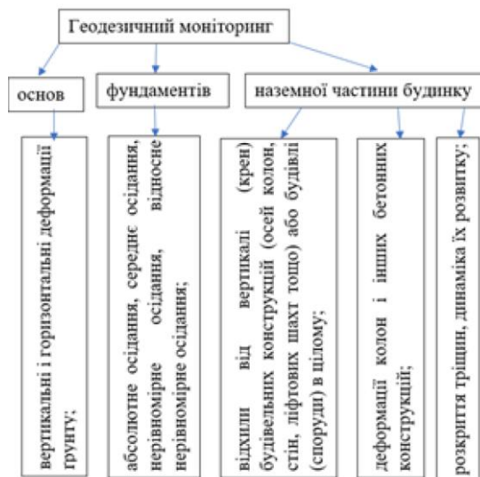
Рис. 3.4. Визначення деформацій будівель [2, с. 22]
