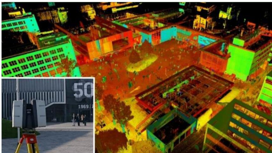
Рис. 3.2. 3D-зйомка будівлі (лазерне сканування) [28]
