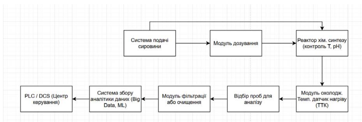
Рисунок 2.2 – Функціональна схема автоматизованої хімічної лінії
