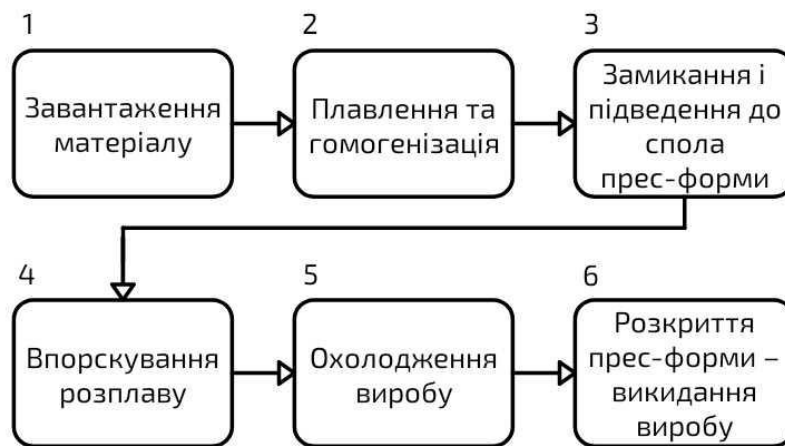
Рисунок 3.1. Структурна схема основних етапів роботи термопластавтомату.
