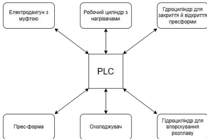
Рисунок 3.2. Функціональна схема системи.
