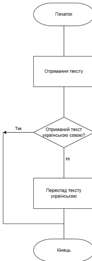
Рисунок 2.2 – Схема алгоритму перекладу тексту публікацій
