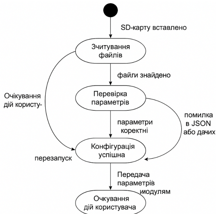
Рисунок 2.2 – Діаграма станів конфігураційного модуля
