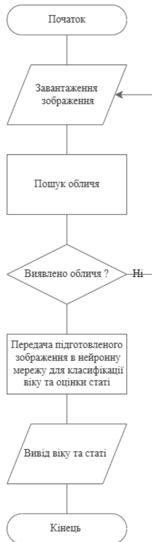
Рисунок 1 — Блок-схема програмного модуля виявлення облич, визначення віку та статі
