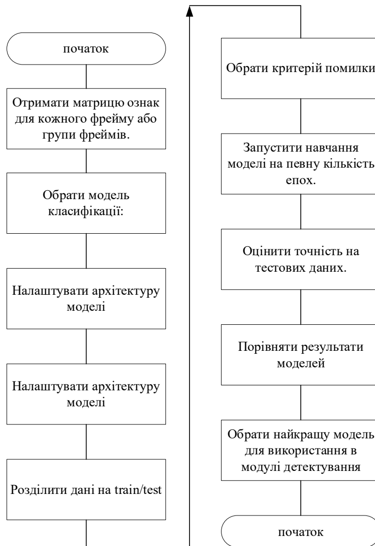
Рисунок 2.8 - Схема алгоритму класифікації
