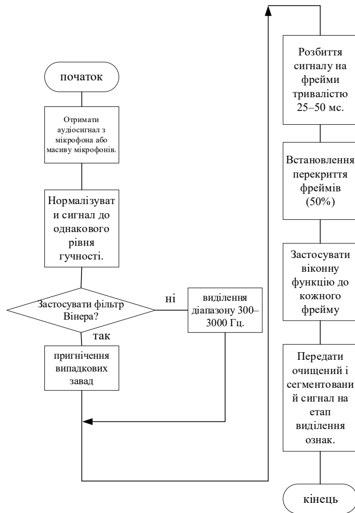
Рисунок 2.6 - Схема алгоритму попередньої обробки
