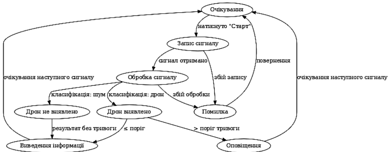
Рисунок 3.3 – Діаграма станів інтерфейсу користувача
