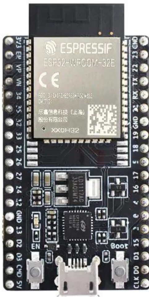
Рисунок 3.3 – Плата розробника ESP-WROOM-32 ESP-32
