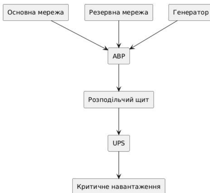
Рисунок 2.8 – Узагальнена схема системи аварійного електропостачання
