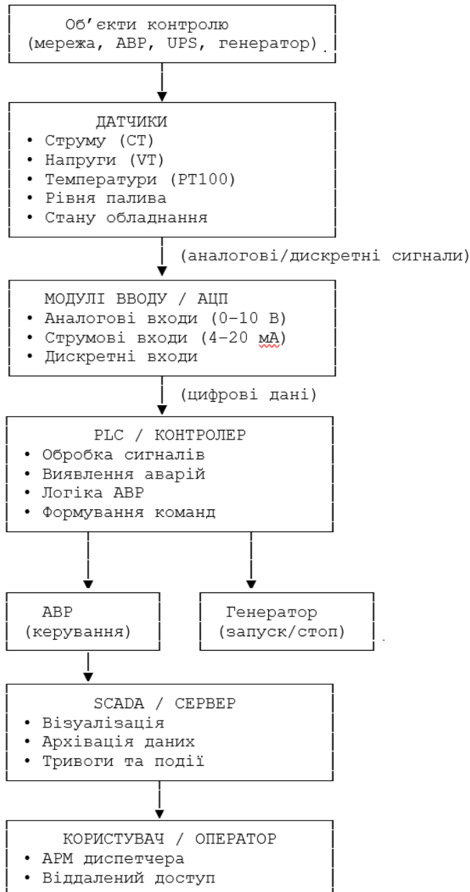
Рисунок 2.9 – Структурна схема інформаційно-вимірювальної системи контролю та діагностики електропостачання
