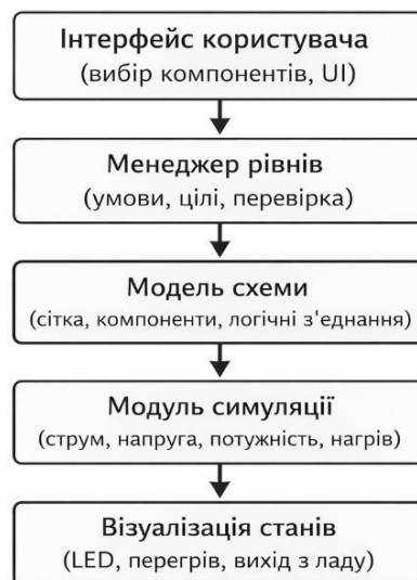
Рисунок 1 – Архітектура інтерактивного симулятора електронних схем
