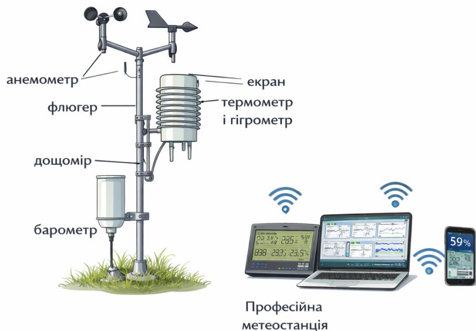
Рисунок 1.8 – Узагальнена структура метеорологічної вимірювальної станції
