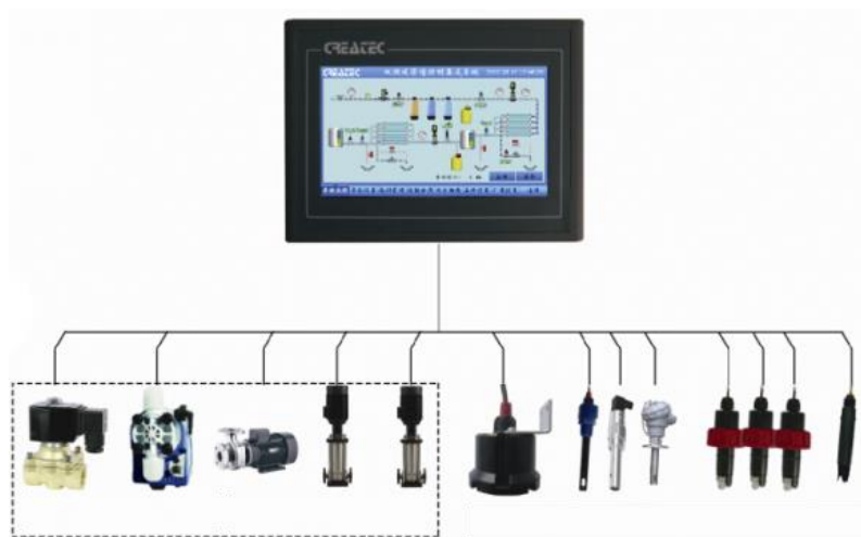
Рисунок 1.5 – ПЛК та його обв'язка автоматизованої системи зворотного осмосу
