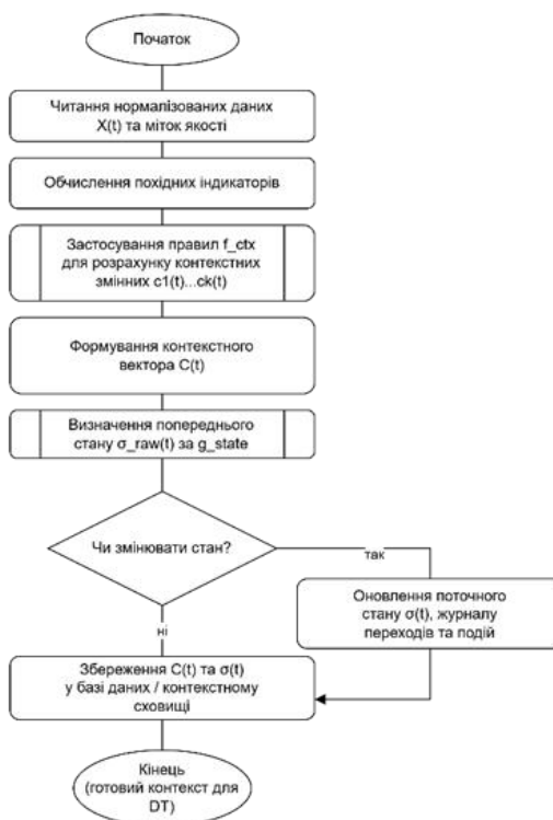
Рис. 2. Алгоритм побудови та оновлення контекстної моделі цифрового двійника
