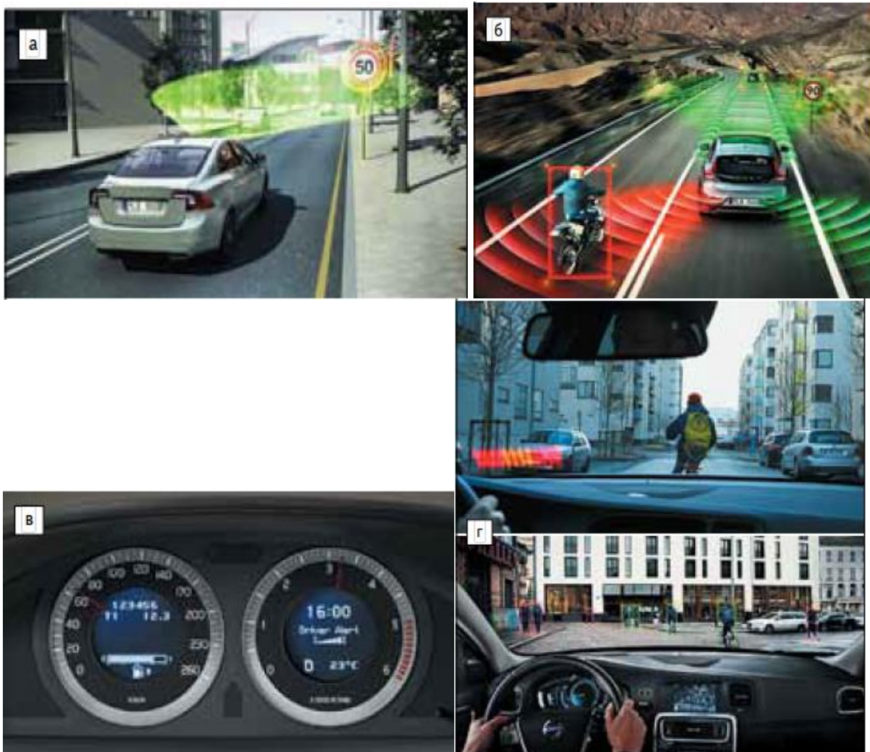
Рисунок 1.2 – Застосування технології Mobileye для опрацювання сигналів відеокамер та радарів в автомобілях Volvo V40: а) виявлення дорожніх знаків; б) утримання в полосі; в) моніторинг стану водія; г) технологія виявлення пішохода/велосипедиста за допомогою одного і того ж блоку з функцією повного автоматичного гальмування.
