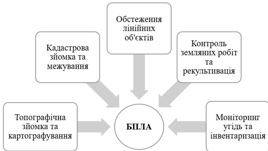
Рис. 1.3. Основні сфери застосування БПЛА у геодезії та землеустрої
