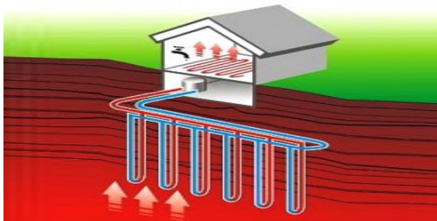
Рисунок 1.12- Тепловий насос «вода-вода»
