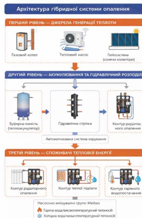
Рисунок 2.6-Трирівнева гібридна система опалення
